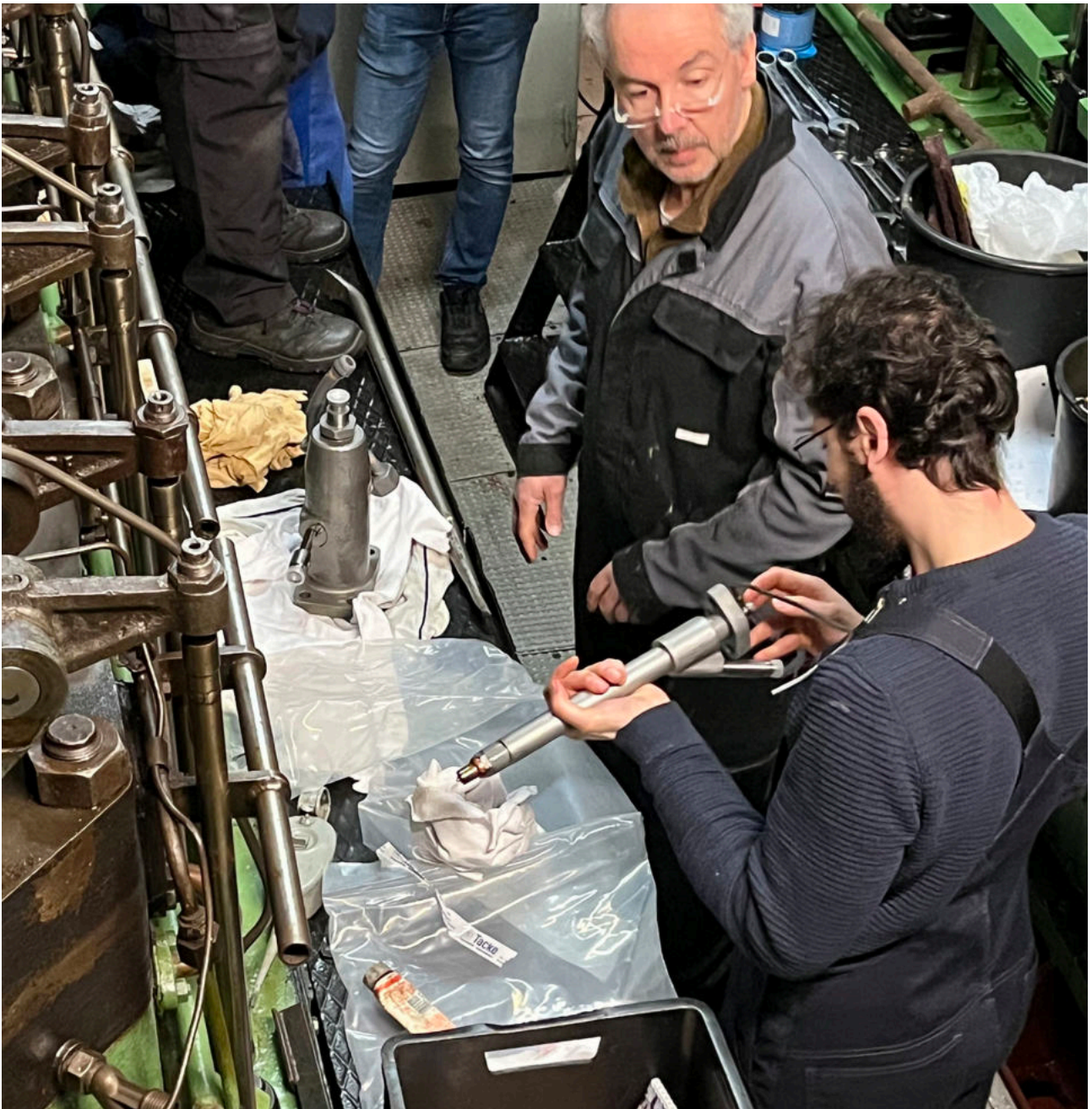
Studierende der Seefahrtsschule Cuxhaven bei der Pumpenmontage im Maschinenraum der GERA, Foto: Dr. Kai Kähler
