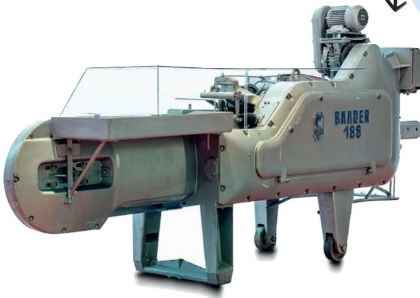
Diese Maschine aus den 1980er-Jahren kam beim Zerlegen von Fischen auf Schiffen zum Einsatz.
